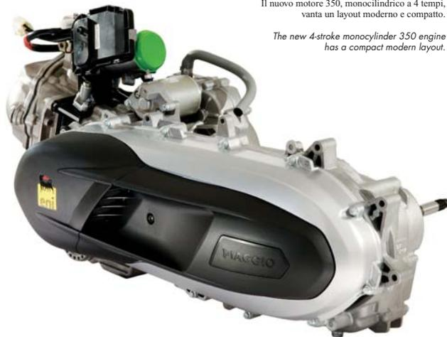
Il nuovo motore 350, monocilindrico a 4 tempi, vanta un layout moderno e compatto.
